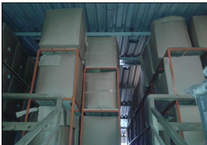
Figura 3: Mezanino com suportes de aço para alocação das caixas
